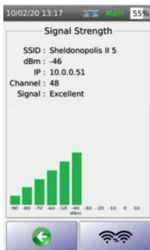
TestProは、移動/追加/変更や一般的なトラブルシューティングに役立ちます。AD-NETCABLEアダプターを介してライブネットワークに接続するか、オプションのEdimax Wi-FiUSBアダプターを使用してワイヤレスで接続します。
