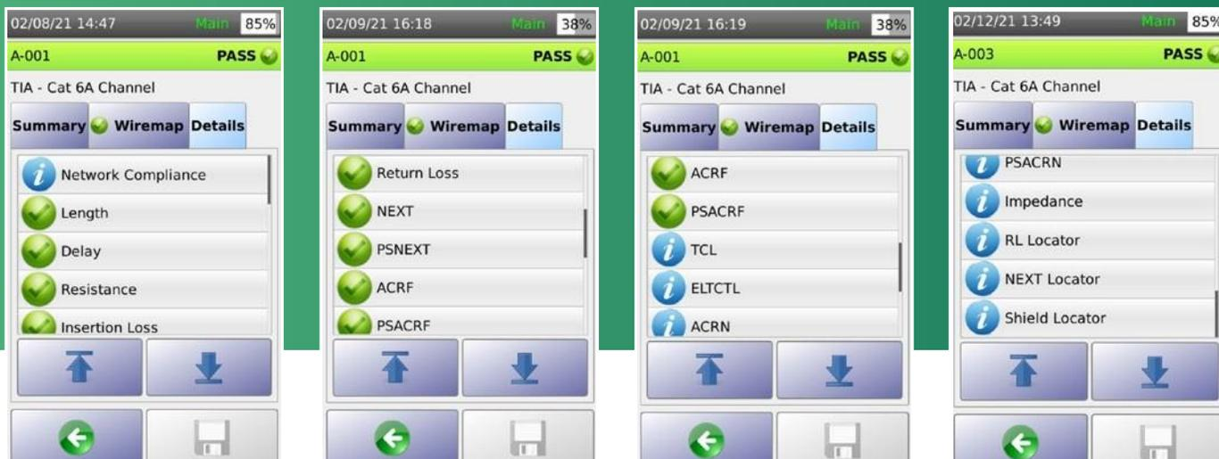
TestProは、Cat 5e、6、6A、7、8、またはクラスI / IIケーブルシステム用の最大40ギガビットイーサネットのネットワーク展開のテストと認定をサポートします。電氣的に中央に配置されたテストプラグは、Cat 8 / クラスI / IIのフィールドテストをサポートするために必要なレベル2G / VIの精度を保証し、実際には2000 MHzの要件を超えて、3000MHzのプラットフォームを提供します。その結果、全周波数範囲で結果に自信を持てるようになります。
